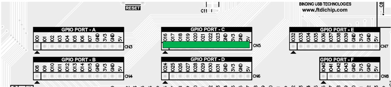
Figure 5.4 : GPIO[16:23] Connector CN5
